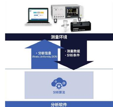
电极片涂布、干燥、辊压后——电极电阻测试系统RM2610测试LIB电极片敷料层与集流体之间的界面电阻
