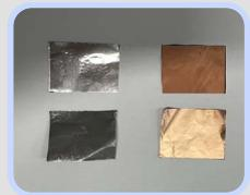
使用**电阻计RM3545**搭配**4探针测试线RM9010-02**和**PC应用软件**，通过4探针法测量**单层材质集流体 1**的**体积电阻率**即可，该方案同样适用于其它各类导电材料。
