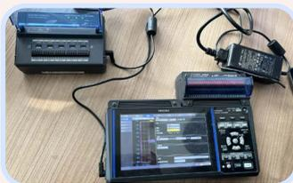
使用**数据采集仪LR8450-01**搭配**无线应变单元LR8534**和**应变片**，并设置**采样间隔为1s**。
