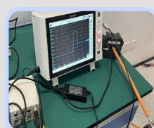
可以采用**存储记录仪MR6000搭配高速模拟单元U8976**以及**电流传感器CT6904A**对信号进行捕捉和记录，由于测试**DC**信号，将采样率设置为**100kS/s**，目的是选择适当采样率实现更长时间的测试。目前许多主机厂客户均在使用该方案。
